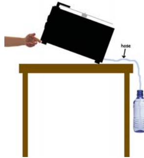
Photo 6 : drainage du liquide de nettoyage
